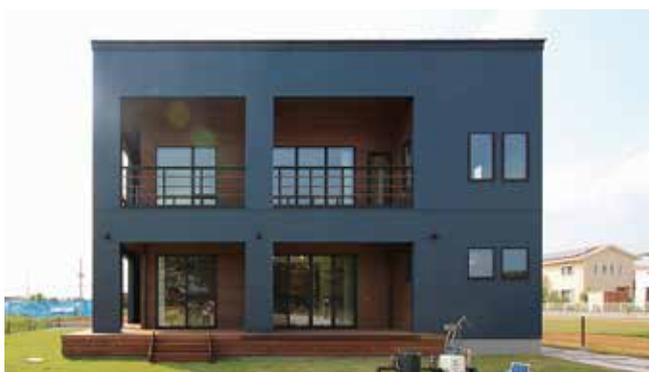
2×4(ツーバイフォー)工法(木造枠組壁工法)とは、木質パネルを組み立てて建物をつくる工法です。「枠組壁工法」のツーバイフォー住宅は、耐震性と耐久性に優れた住まいです。施工時の品質の確かさも特性です。一番多く使用される角材の断面寸法が2×4インチであることからこう呼ばれるようになりました。米では90%以上がこの工法によって建てられています。
